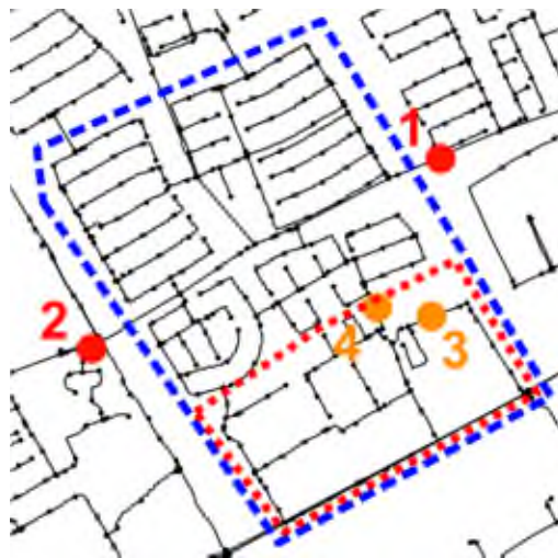
Figuur 18. Locaties van de gesimuleerde warmtewisselaars. De rode cirkels (locatie 1 en 2) geven de locaties weer op de grootste ingaande volumestromen. De oranje cirkels (locatie 3 en 4) geven de locaties weer wanneer volumestromen naar een deel van de Danswijk (binnen rode markering) voorzien worden van een warmtewisselaar.
