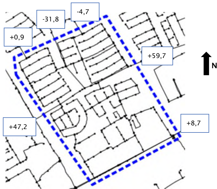
Figuur 17. Drinkwaterinfrastructuur Danswijk met inkomende en uitgaande volumestromen ( \text{m}^3/\text{h} ) op piekmoment (8.00 uur).
